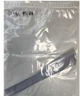
Fig 3. 인장강도 측정용 종이 절편
